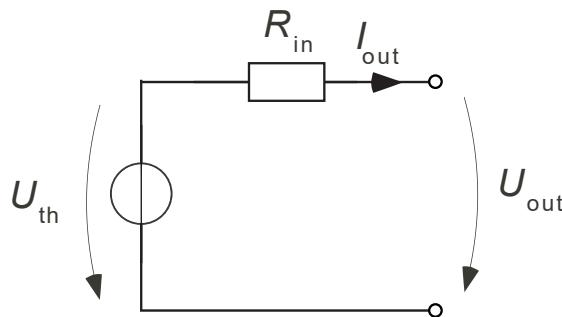
3. Retrouver  $U_{th}$  et  $R_{in}$  du circuit équivalent de Thévenin à l'aide de la méthode vue en cours (Rappel : Vous avez déjà calculé  $U_{th}$  au point 1). Comparez la pente du graphique obtenu au point 2 à  $R_{in}$ .
