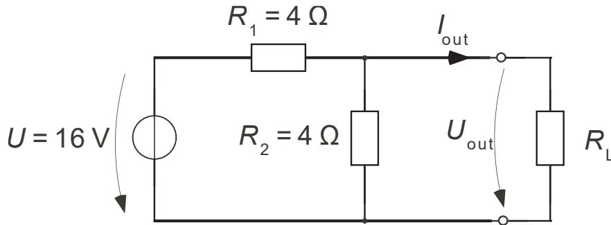
Ce genre de montages doivent être vus comme deux dipôles connectés l'un à l'autre : un circuit « source » et une « charge » (ici il s'agit de  $R_L$ ).
