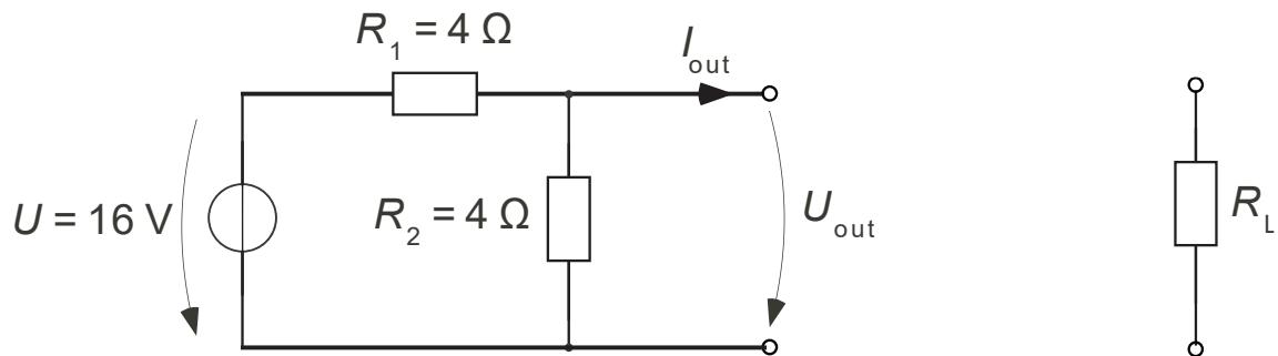
Le circuit fournit de la tension et du courant à la charge, ou vu autrement, on peut dire que la charge sollicite le circuit et en tire du courant (pour prendre un exemple concret, on peut imaginer que le circuit est censé représenter le réseau électrique de votre lieu d'habitation, avec comme sortie une prise dans votre chambre, et que la charge est une résistance qui représente votre lampe de bureau).
