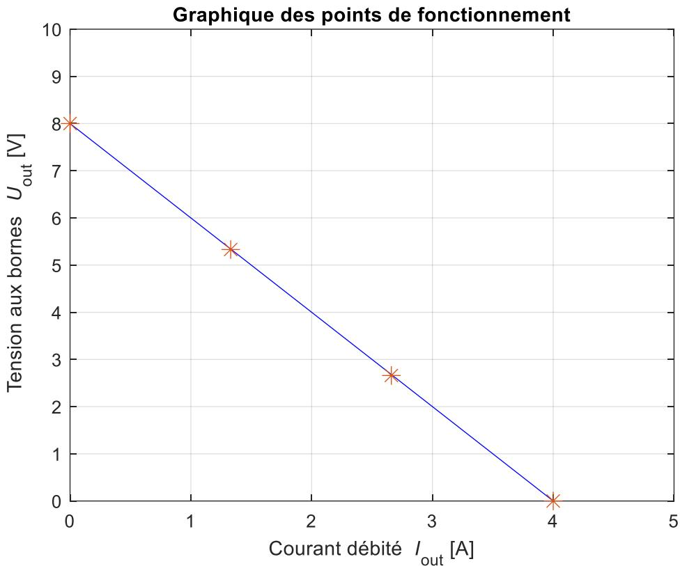
Les points calculés se trouvent clairement sur une même droite, ce qui indique que la relation entre courant et tension fournis par un circuit est linéaire. La pente de cette droite vaut : -2 V/A.
